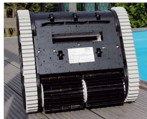
Das Reinigungssystem: die Lamellenrollen lösen den Schmutz und fördern ihn in Richtung der Saugöffnung. Die kleinen Rollen sorgen für den korrekten Bodenabstand. Die Wischlippe hinter der Saugöffnung sorgt dafür, dass nicht zu viel Schmutz unter der Maschine durchgespült wird
